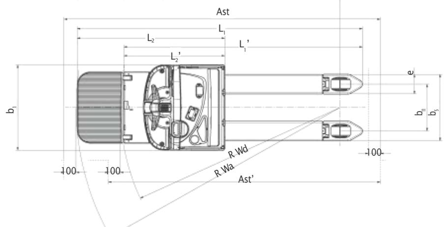
Vue de dessus de l'EXU avec plate-forme de conduite en option
