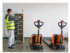
Station de chargement permettant de charger jusqu'à 5 batteries simultanément sur un même HUB avec possibilité d'en coupler plusieurs. Indicateur du niveau de charge en temps réél de chaque batterie et équipé d'un système d'alarme avec extincteur intégré
