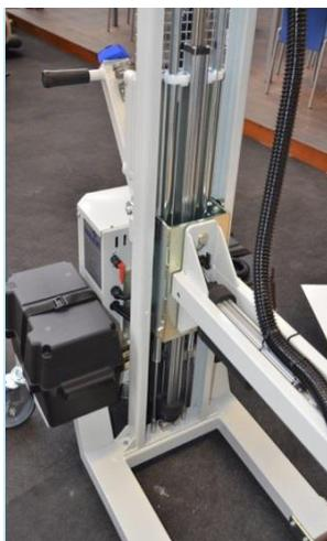
Il est possible de déconnecter le groupe de soulèvement à vide de la MobyLift pour pouvoir monter d'autres systèmes de soulèvement.
