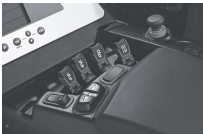
Pilotage simple de toutes les fonctions sans changement de position de la main – par à l'aide quatre mini-leviers (Fingertip)
