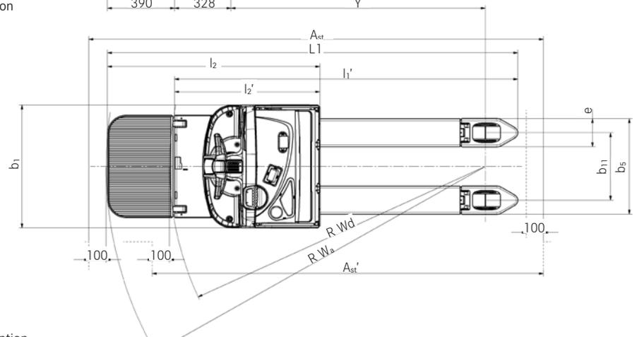
Vue de dessus de l'EXU avec plate-forme de conduite en option
