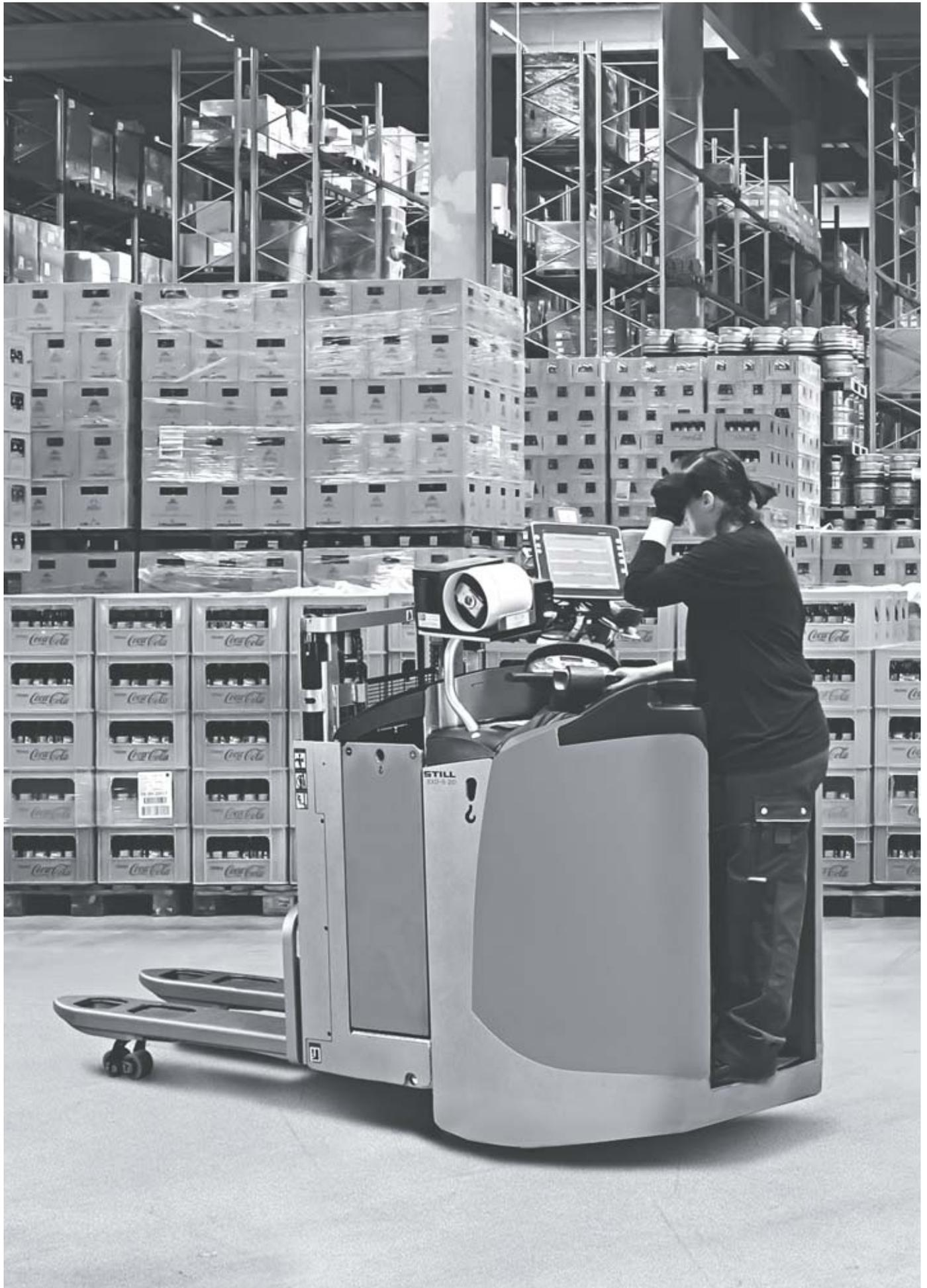
EXD-SF Gerbeur à double niveau avec plate-forme rabattable
