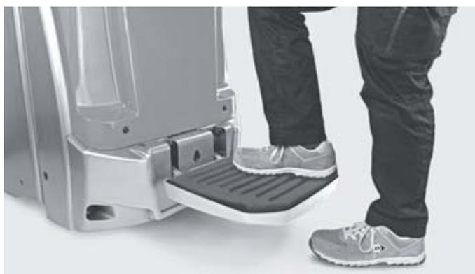
Préservation du dos : plate-forme à suspension pneumatique réglable en fonction du poids de chaque cariste
