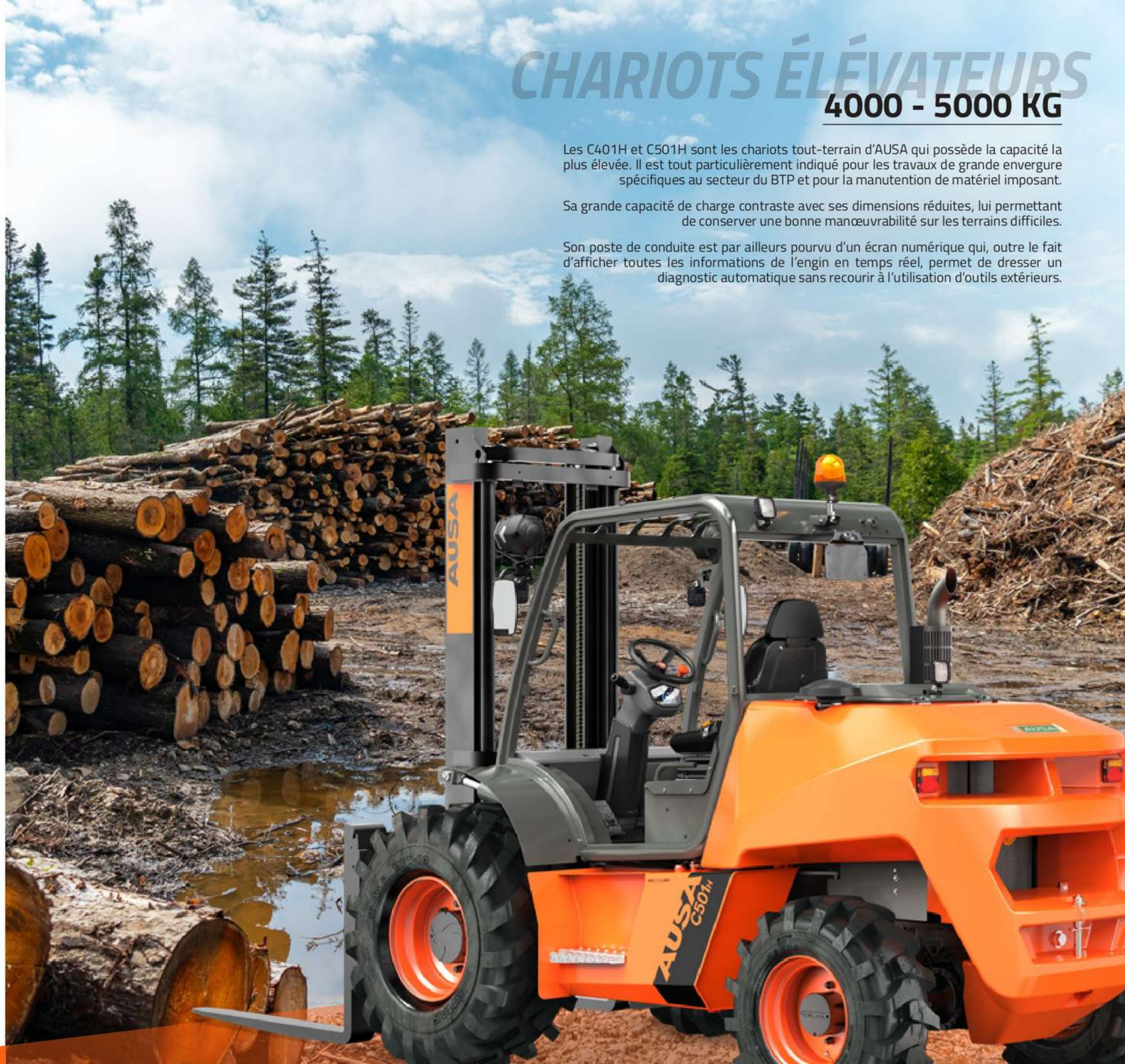
C401H 4000KG TRACTION 4x4 FULLGRIP® PUISSANCE 55,4KW LARGEUR 2.010MM TRANSMISSION HYDROSTATIQUE
