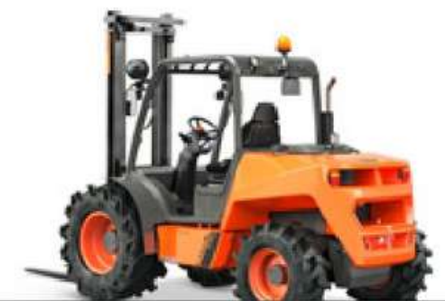
C351H 3500KG TRACTION 4x4 FULLGRIP® PUISSANCE 36,5KW LARGEUR 1 780MM TRANSMISSION HYDROSTATIQUE
