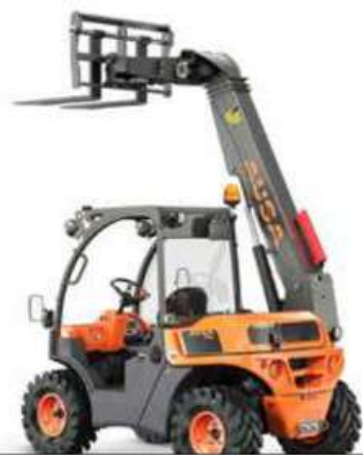
T144H 1350 KG LEVÉE MAXIMALE 4 000MM PUISSANCE 18,5KW LARGEUR 1 405MM TRANSMISSION HYDROSTATIQUE
