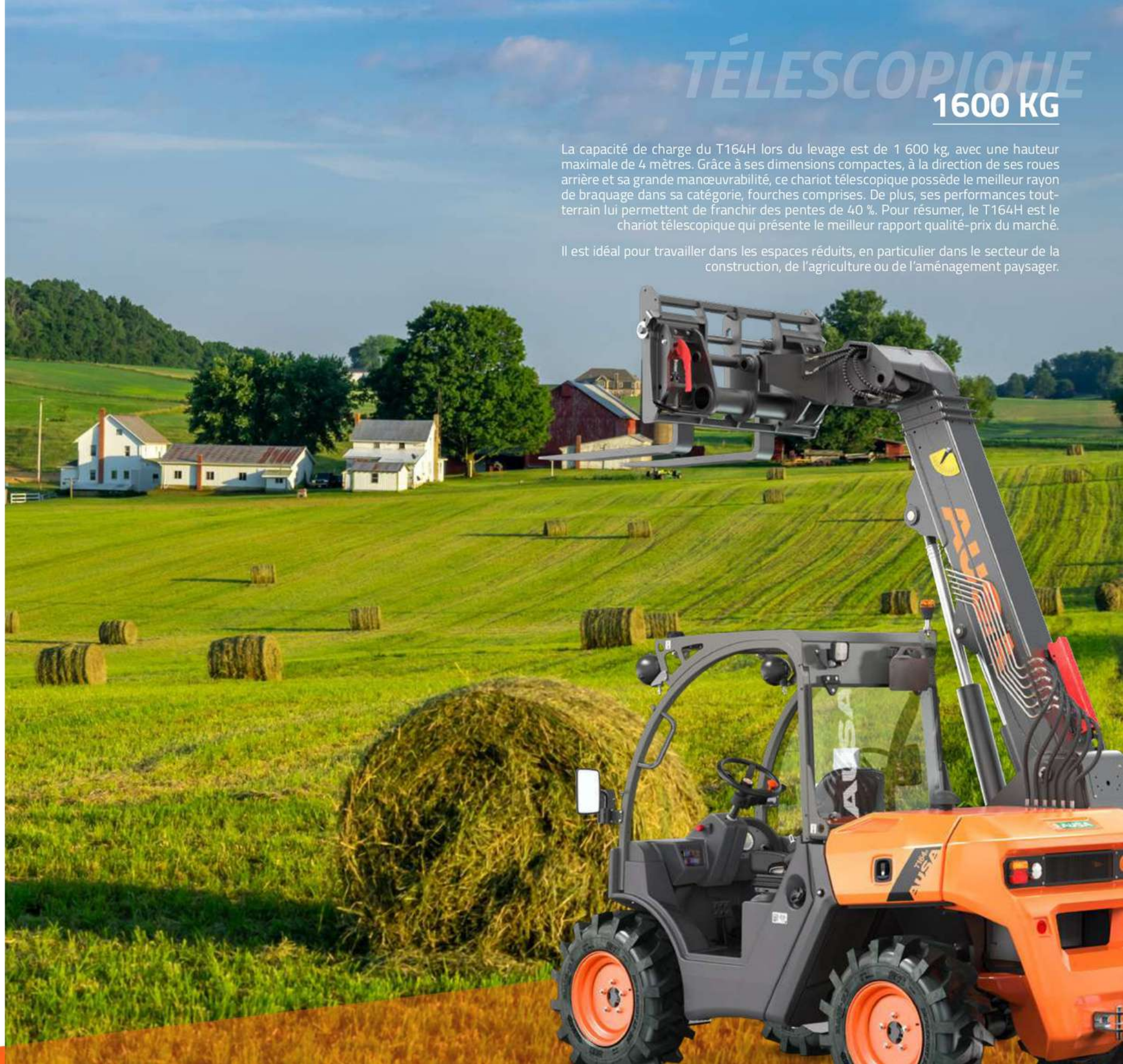
T164H 1600 KG LEVÉE MAXIMALE 4.000MM PUISSANCE 18,5KW LARGEUR 1.480MM TRANSMISSION HYDROSTATIQUE
